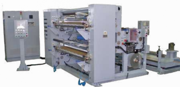
TG194C型 特殊シャーカット式スリッター 主用途: 電解銅箔、圧延銅箔
