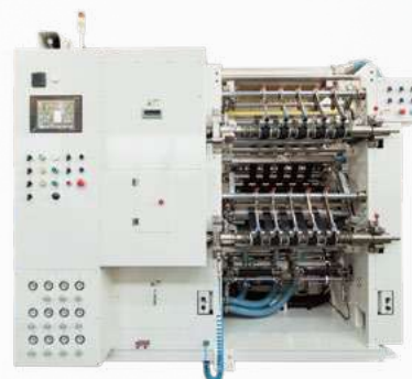
TG124E型 特殊シャーカット式スリッター 主用途: LIB用電極材(正極材、負極材)、EDLC、CCL、FCCL
